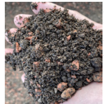
Staudensubstrat mit Ziegelbruch als Wasserspeicher
