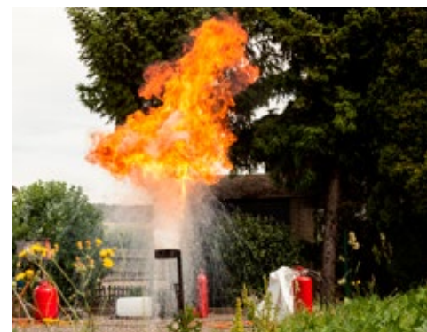
Wasserdampfexplosion nach Löschversuch von brennendem Fett mit Wasser
